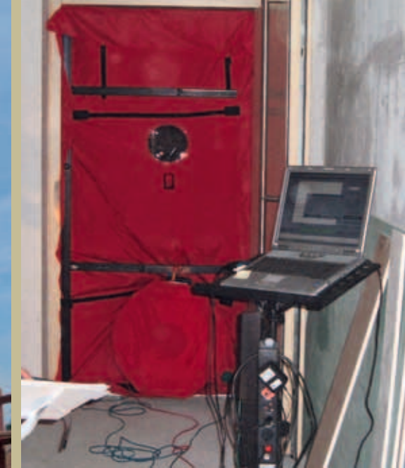
A légtömörség a passívház egyik alapfeltétele. Ennek garanciája a Blower-door-mérés, és egyik fontos kiegészítő eszköze az illesztési hézagokra alkalmazott különleges ragasztószalag.
